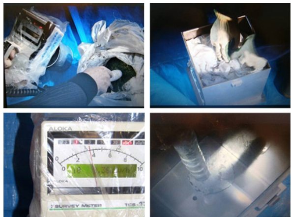
写真3. 試作機遮蔽検査工程画像 ステンレスクラッド遮蔽ボックスを製品化するに至ったのです。
