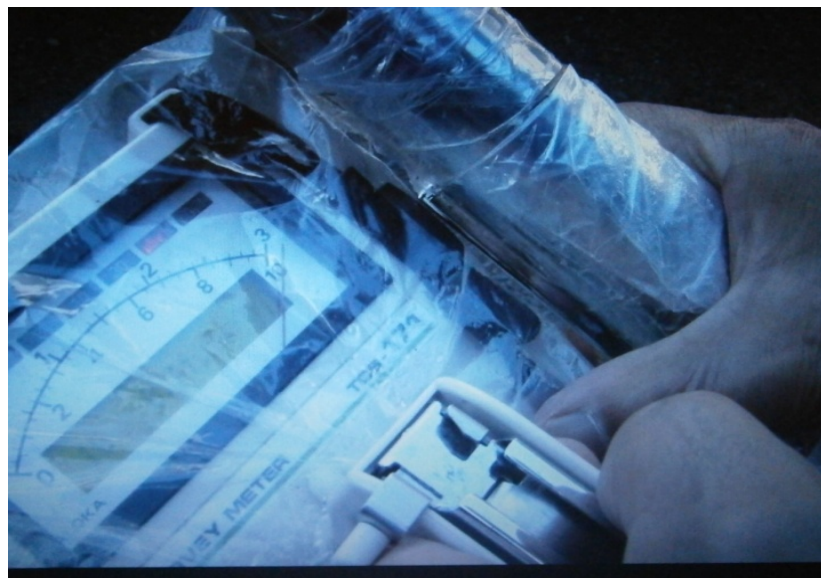
①日立アロカ シンチレーション(測定器)のアイドルング
